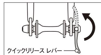
④クイックリリースレバーを CLOSE の刻印が見える位置へ力を入れて倒します。
