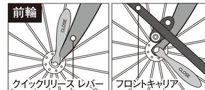
⑤前輪のクイックリリースレバーと後輪のクイックリリースレバーはイラストの方向へ倒してください。ただし、フロントキャリアを取り付けた状態ではキャリアと平行に倒してください。
