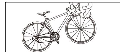
③クイックリリースレバーを一旦おろし自転車を浮かせ、車輪を強く叩き、車輪が外れないか確認してください。この時車輪が外れる場合、②に戻りセットナットをさらに締めます。
