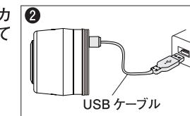
付属のUSBケーブルを本体のUSBポートと給電が可能なUSBポートに挿入します。接続すると自動的に充電を開始し、ライトが点灯します。満充電までの時間は約2時間です。
