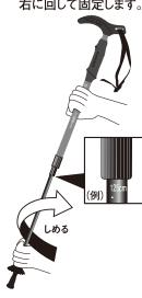
③中段シャフトを下 段シャフトと同じ 要領で伸ばしま す。下段シャフトと 同じ目盛に合わ せ、右に回して固 定します。
