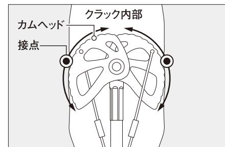
②カムを先にしてステムを予測される加重がかかる方向に可能な限り向けた状態でクラックに差し込みます(A)。このとき加重がかかる方向に対して直角にセット(B)すると本製品が脱落する可能性が高く非常に危険ですのでおやめください。クラックの角をまたいだ状態でのセット(C)はステムが損傷する恐れがあるので避けてください。
