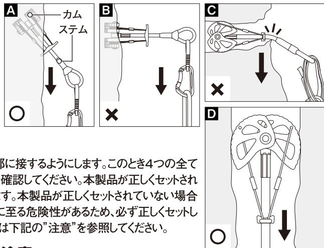
③トリガーから指を離し、カムがクラック内部に接するようにします。このとき4つの全てのカムがクラック内部に接していることを確認してください。本製品が正しくセットされた場合は右図(D)のような状態になります。本製品が正しくセットされていない場合は脱落などにより傷害や死亡事故などに至る危険性があるため、必ず正しくセットしてください。不適切なセット方法については下記の“注意”を参照してください。
