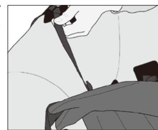
⑤シートバックの左右のストラップを艇本体付属の左右のバックルに通し固定します。
