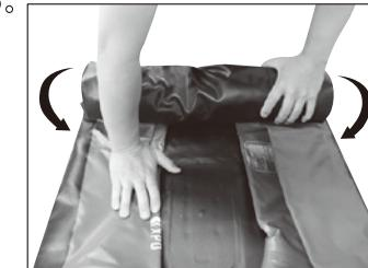
③フィンボックスがあるモデルは船体の末端を被せ、フィンボックスが折れないように注意してください。
