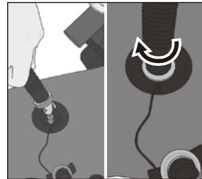
③ポンプを上げ下げし、空気を1psi～3psiの範囲で調節してください。空気を入れ過ぎないように注意してください。
