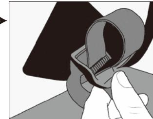
④シートバック背面のバックルと艇本体付属のバックルにコンプレッションストラップ(金属製のDリング付きテープ)を通し固定します。余ったテープはシートと本体背面の間に収納します。
