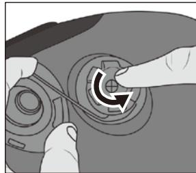
②付属のハンドポンプを差し込み、時計回りに回して固定します。
