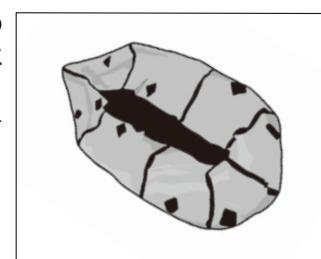
②船体の両サイドを内側に折り込み、写真のように後方からパレット開口部に向かって巻きながら空気を抜いていきます。
