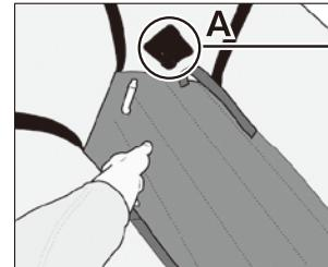
③シート前側のストラップをシート前方にある艇本体付属のバックルに通し、左右両側とも取り付けます。
